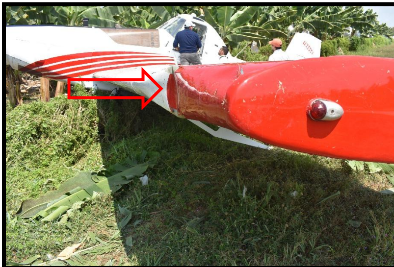
Fotografía No. 6 Golpe en borde de ataque, plano izquierdo.
