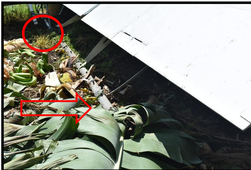
Fotografía No. 10 Daños en las boquillas del sistema de aspersión, plano derecho.
