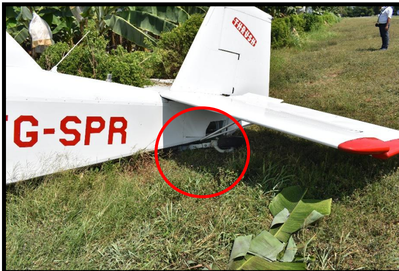
Fotografía No. 8 Tren de patín (cola) fracturado en su base con el fuselaje.
