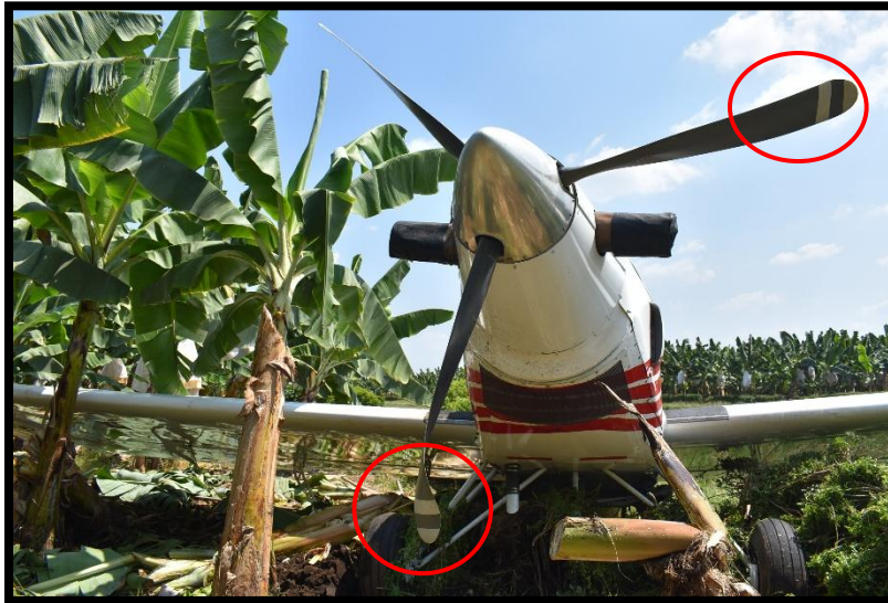
Fotografía No. 3 Daños en dos palas de la hélice.
