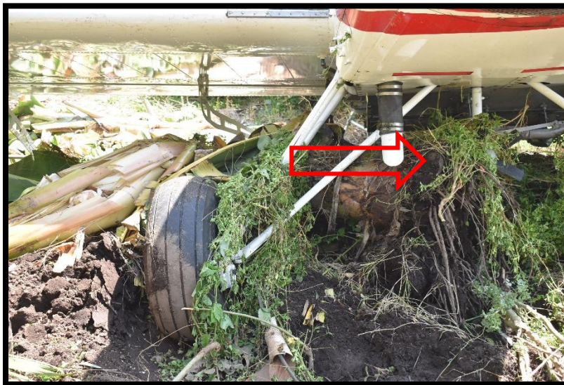
Fotografía No. 4 Daño en el motor del sistema de aspersión.
