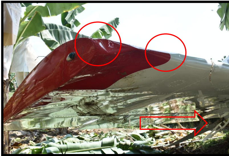
Fotografía No. 11 Golpes en el borde de ataque y daños en las bases del sistema de aspersión, plano derecho inferior.
