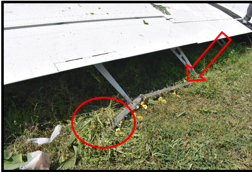
Fotografía No. 7 Daños en las boquillas del sistema de aspersión del plano izquierdo.
